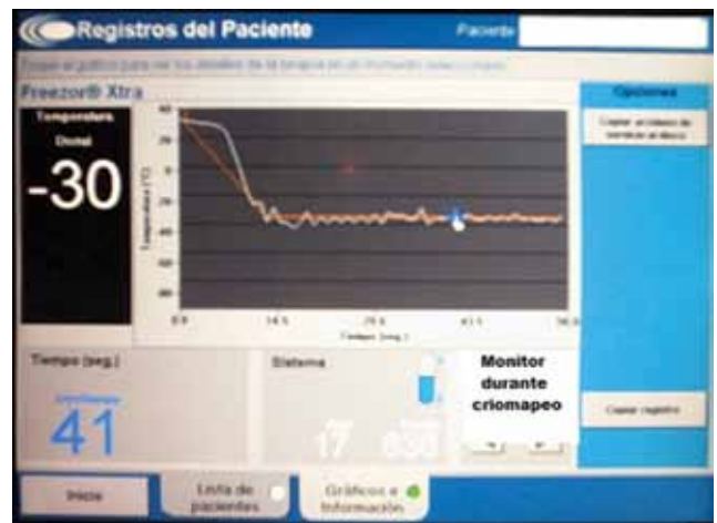
Figura 6. Registro durante criomapeo a -30^{\circ}\text{C} . La curva permite apreciar cómo se alcanzó la temperatura deseada en menos de 15 segundos.
